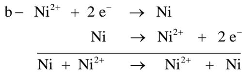
c- Electrolyse à anode soluble.
