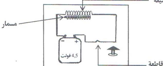
**التعليمية :** أذكر سببين يقويان المفعول المغناطيسي للتيار الكهربائي بالاستناد إلى التجربة المقترحة
