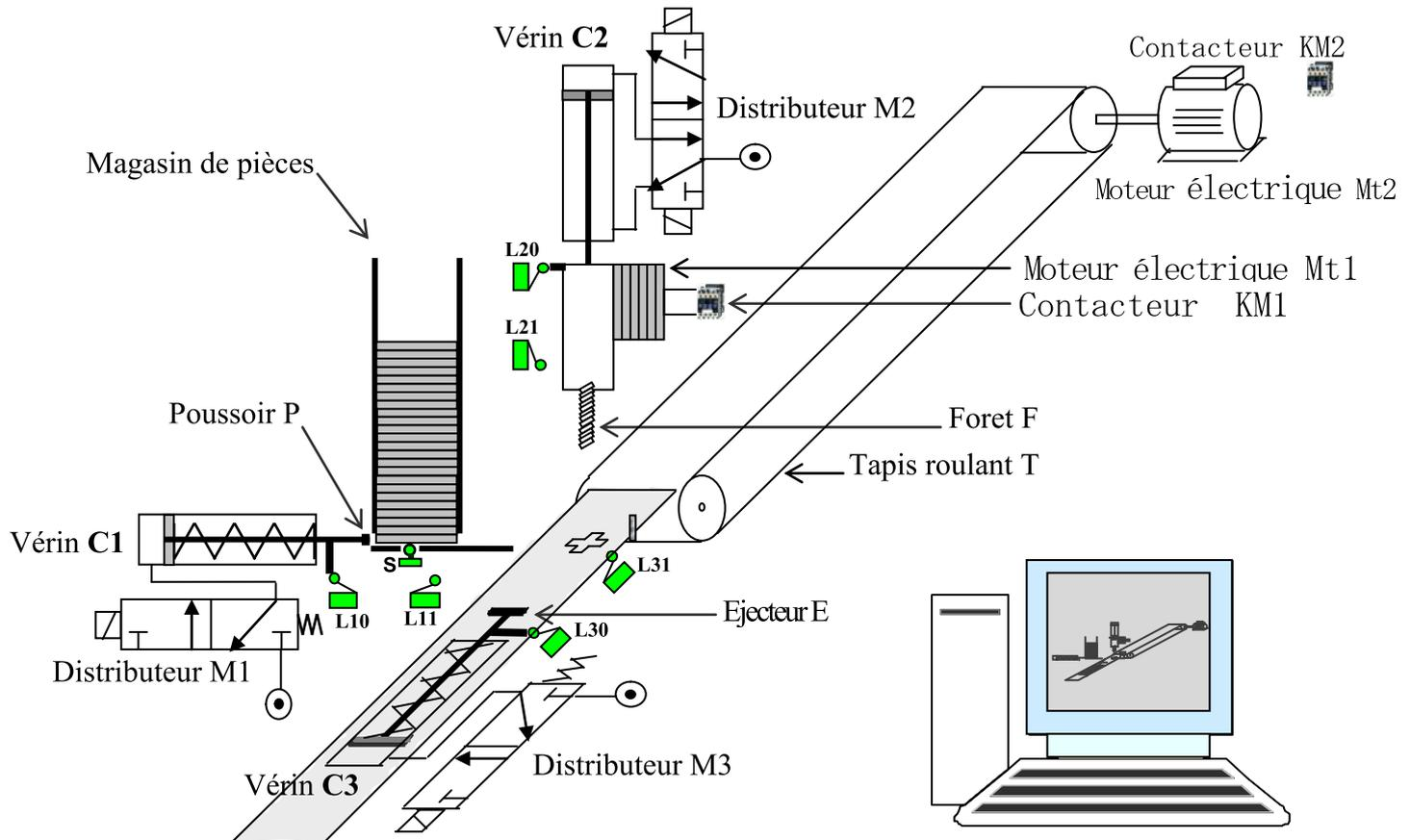
Ce système permet de percer des pièces. Il se compose de :
