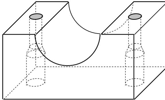
**Forme globale de la pièce :** parallélépipède contenant une rainure transversale qui a une forme d'un demi-cylindre dans la partie supérieure.
