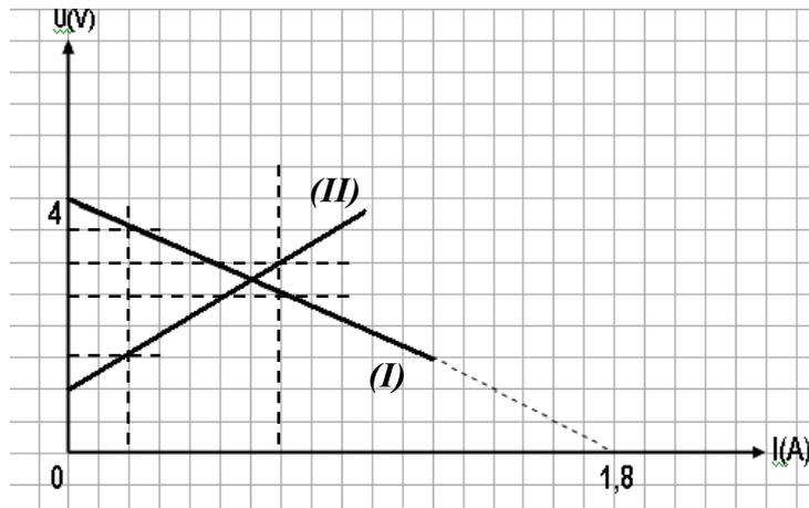
1. Les courbes (I) et (II) ci-dessus représentent respectivement les caractéristiques intensité tension d'un générateur et d'un électrolyseur montés en série :
