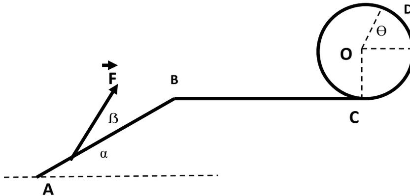
un solide (s) de masse  $m = 700 \text{ g}$  se déplace à vitesse constante sur une piste ABCD, Sur le trajet AB il est soumis à une force constante  $\vec{F}$  de valeur  $80\text{N}$  et faisant un angle  $\beta$  avec le plan incliné AB (voir schéma) .
