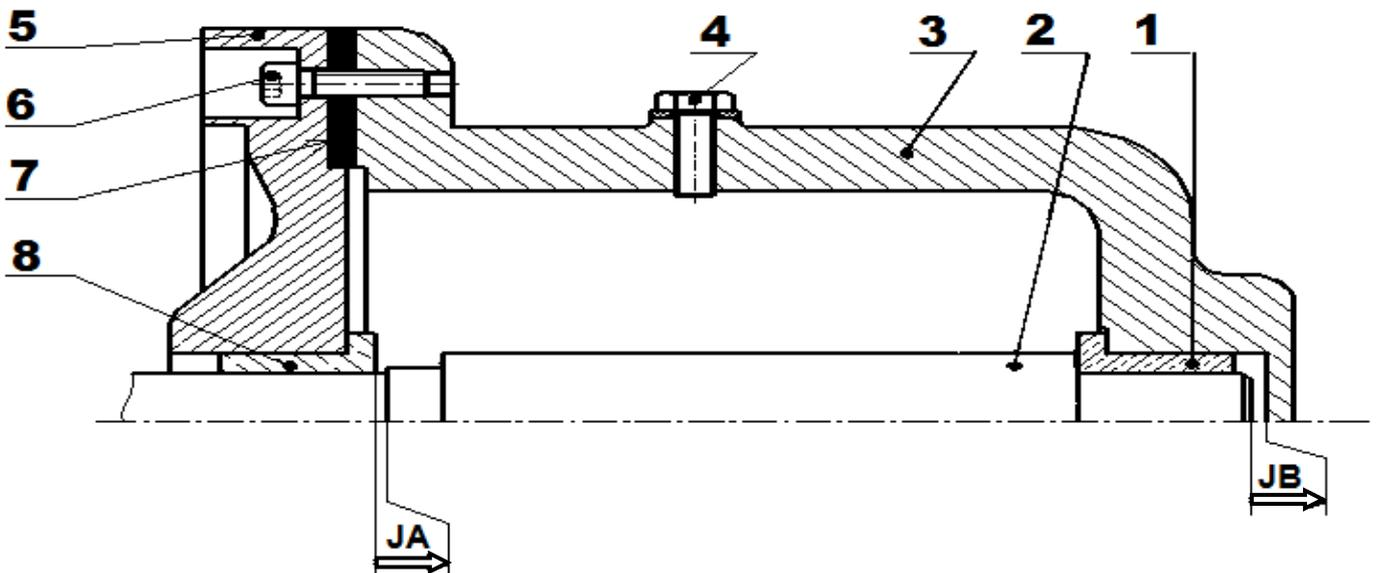
2. Compléter le diagramme de liaison minimale relative à la condition **JA** : (0.75 points)
