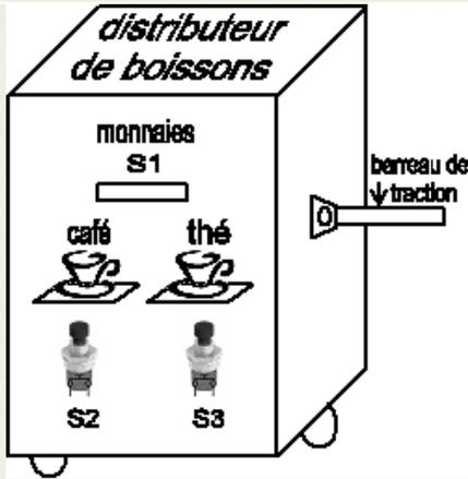
**Description :** Le distributeur comporte 2 réservoirs. L'un pour le café et l'autre pour le thé. L'écoulement des boissons est réalisé par 2 électrovannes EV1 et EV2 commandées respectivement par 2 boutons poussoirs S2 et S3. Pour avoir du boisson, il faut introduire 2 cents millimes qui seront détectés par le capteur S1.
