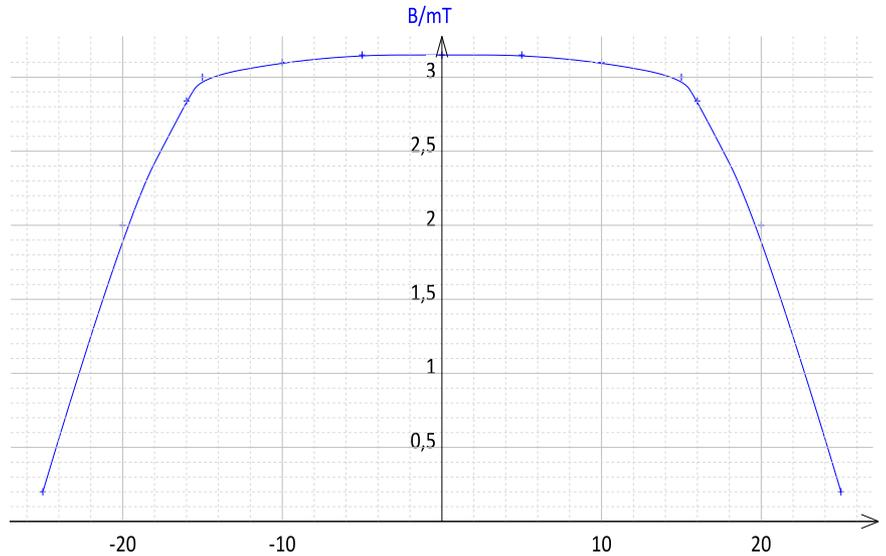
Les mesures effectuées permettent de tracer la courbe la courbe  $\|\vec{B}\|=f(x)$ , reproduite ci-après, x étant l'abscisse de la sonde à partir de O. Durant ces mesures, l'intensité du courant vaut **5A**.
