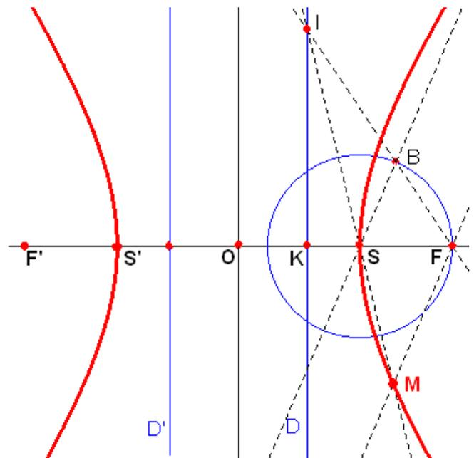
**Construction d'un point d'une hyperbole de foyer  $F$ , de directrice  $D$  et d'excentricité  $e$**
