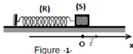
Ce solide subit une force de frottement visqueux  $\vec{f} = -h\vec{v}$  avec h un coefficient positif et  $\vec{v}$  est le vecteur vitesse de G. En régime permanent, l'équation horaire du mouvement de G est de type  $x(t) = X_m \sin(\omega t + \varphi_x)$ .
