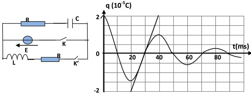
A l'instant initial  $t=0$ , on ferme l'interrupteur  $K$ , le circuit est le siège d'oscillations électriques. La courbe ci-dessus représente l'évolution en fonction du temps de la charge  $q$  de l'armature positive du condensateur.
