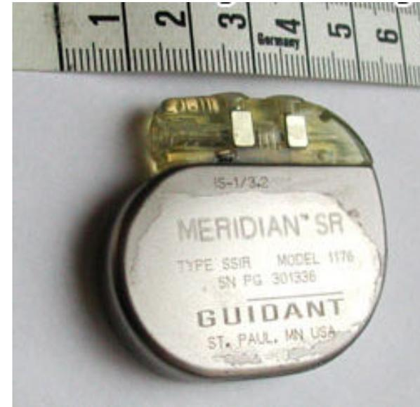
Un **pacemaker** est un appareil implanté dans la poitrine, sous la peau. **Le boîtier contient une batterie et un système électronique.**
