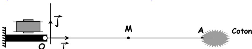
A chaque instant  $t$ , l'onde qui se propage le long de la corde impose au point  $M$  une élongation  $y(t)$  qui est celle de la source à l'instant  $(t - \theta)$ , avec  $\theta$  le temps mis par l'onde pour se propager de  $S$  à  $M$ .
