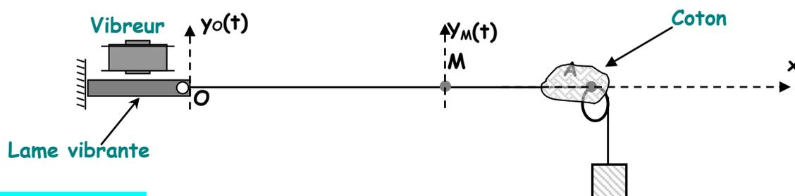
**Rôle de coton :** amorti l'onde en A et évite sa réflexion de sorte que la corde soit le siège uniquement de l'onde progressive
