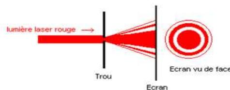
Diffraction par une ouverture circulaire étroite
