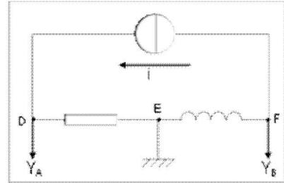
Un oscilloscope permet de relever la tension entre les bornes de la bobine et celles de la résistance. Le générateur de courant est à masse flottante : sa masse électrique n'est pas reliée à la borne terre (la tige métallique des prises de courant).
