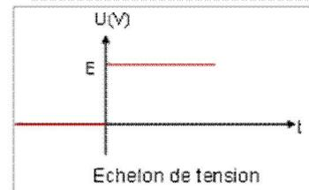
Vous admettez que la solution de l'équation différentielle :  $\frac{dU_C}{dt} + \frac{U_C}{RC} = \frac{E}{RC}$  (ou  $E = U_C + RC \frac{dU_C}{dt}$ ) est de la forme :  $U_C(t) = Ae^{\alpha t} + B$  ( $\alpha$  : lettre grecque « alpha »)
