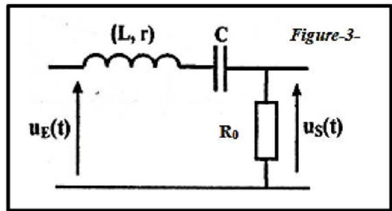
du résistor  $u_S(t) = U_{Sm} \sin(2\pi N t + \phi_s)$ , on détermine la transmittance  $T = \frac{U_{sm}}{U_{EM}}$  du quadripôle.
