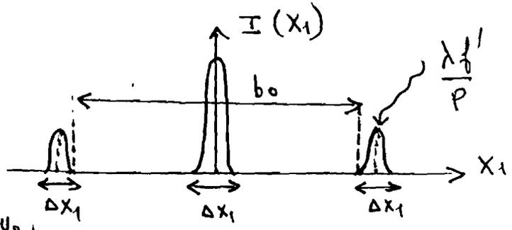
8.c - En occultant les fréquences  $\pm u_0$ , du plan focal image, la figure de diffraction est celle relative à une fente de largeur  $a$  : tout se passe comme si l'objet était une fente de largeur  $a$ . On observe sur l'écran (E) l'image de la fente : bande de largeur  $a$  uniformément éclairée.
