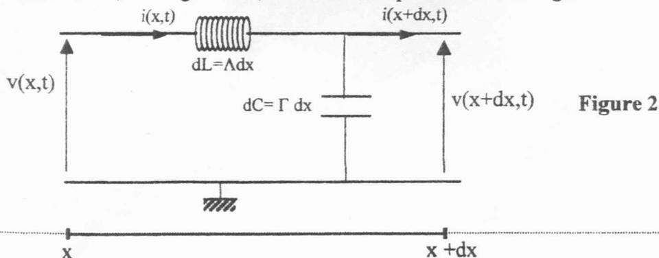
La tension entre les fils conducteurs et l'intensité de courant qui les parcourt sont notées respectivement  $v(x,t)$  et  $i(x,t)$ , à l'abscisse  $x$  et à l'instant  $t$ .
