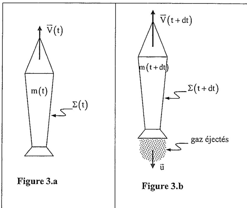
On note  $q_m$  le débit massique, supposé constant, des gaz éjectés à la vitesse  $\bar{u}$  par rapport au référentiel  $(\mathcal{R}')$  lié à la fusée. La résultante des forces extérieures exercées sur le système fermé se réduit à son poids  $\bar{P}$ .
