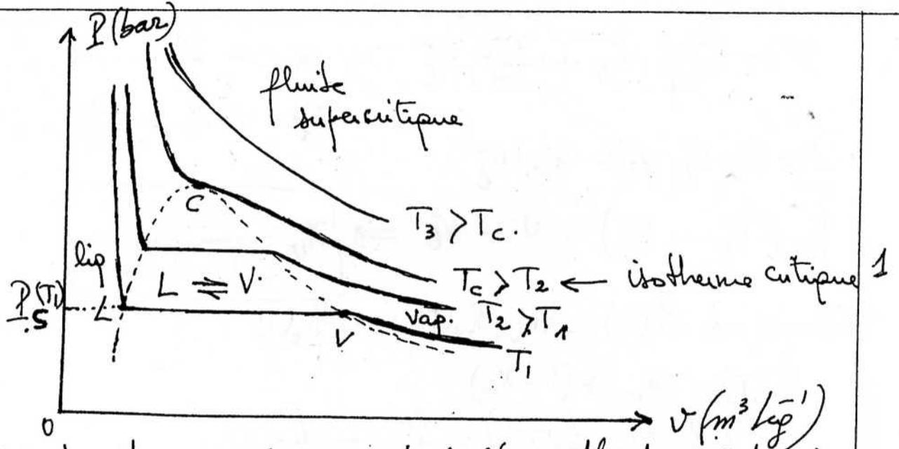
• Courbe de rosée C.V. : c'est l'ensemble de points où la 1<sup>ère</sup> goutte de liquide se forme à une température  $T$ .
